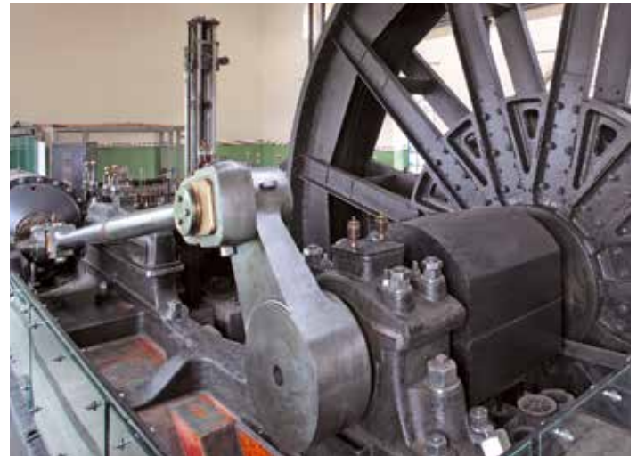
Im Maschinenhaus läuft die Dampffördermaschine aus dem Jahr 1893.
